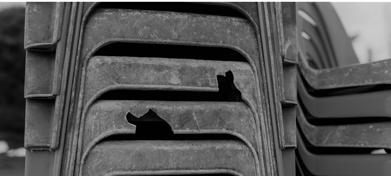
Le sedie da giardino di polipropilene si degradavano rapidamente sotto il sole
